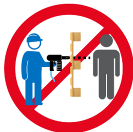
interdit de clouer en face d'un collègue
