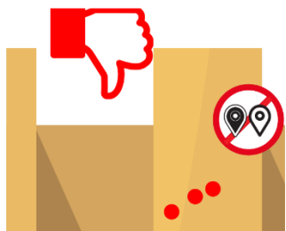
pointes mal placées, trop près
